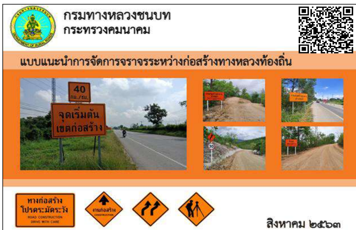
รูปที่ 5-8 แบบแนะนำการจัดการจราจรระหว่างก่อสร้างทางหลวงท้องถิ่น
